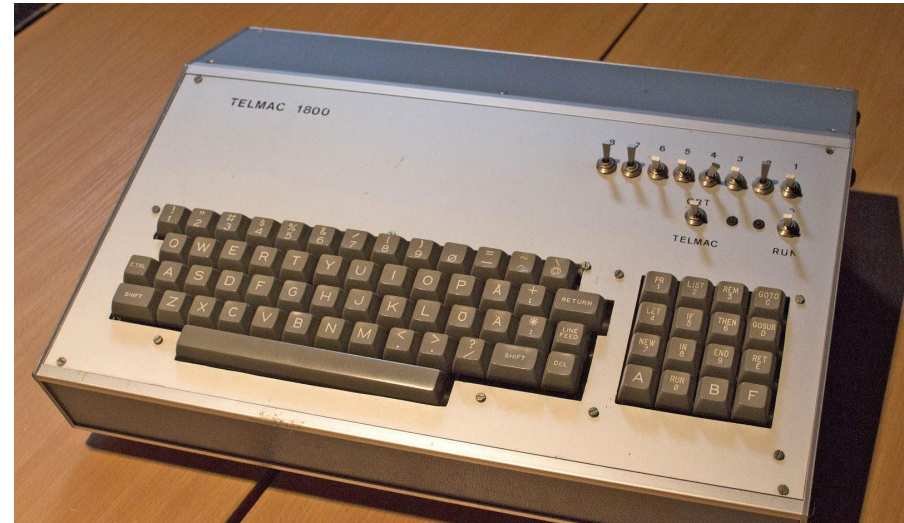
Kuva 1. Telmac TMC-1800 Jari Viitalan kokoelmista. Rakennussarjaan ei sisällynyt kotelo, joten laitteen lopullinen ulkoasu saattoi vaihdella paljonkin.
